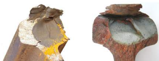
foto nr.8 - secțiuni transversale de rupere
