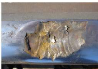
foto nr.6 - extinderea pe verticală a zonelor concave fisurate linia II Km 256+670 șina din partea stângă
